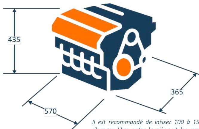
Il est recommandé de laisser 100 à 150 mm d'espace libre entre la pièce et les parois du réservoir pour une diffusion ultrasonique adéquate.
